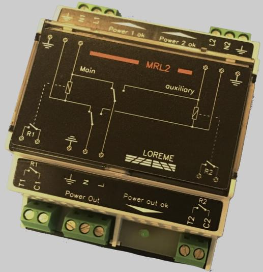
Le module de redondance permet de fournir une protection efficace contre les défaillances d'alimentations AC. Grâce au découplage de deux alimentations, la défaillance de l'une d'elle reste sans impact sur la sortie, l'autre prenant automatiquement sa fonction sans interruption de service. Le module de redondance surveille de façon permanente les deux alimentations, et fournit un signal d'alarme par le biais d'un contact si une défaillance est détectée (perte de redondance).
